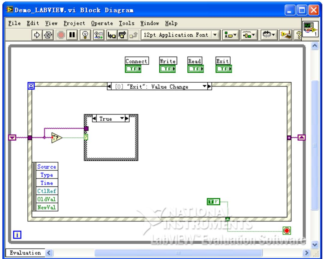
5. 运行程序，出现如下图所示界面。点击 Address 下拉框选择 VISA 资源名称，点击 Connect 连接仪器，在 Command 文本框中输入命令，点击 Write 写入仪器。若为查询命令，点击 Read，Return 文本框显示返回值。
