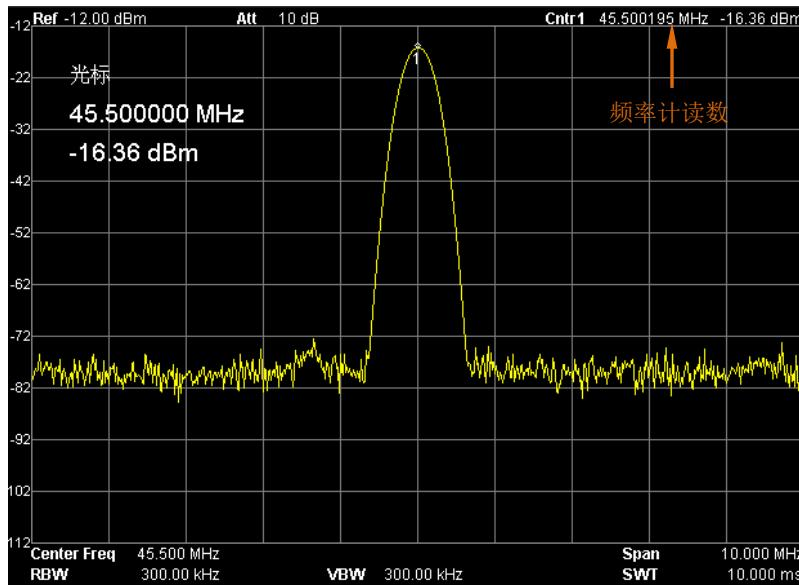
图 2-24 频率计测量
