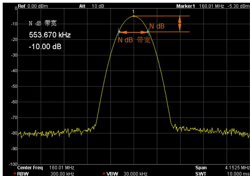
图 2-23 N dB 带宽测量示意图
