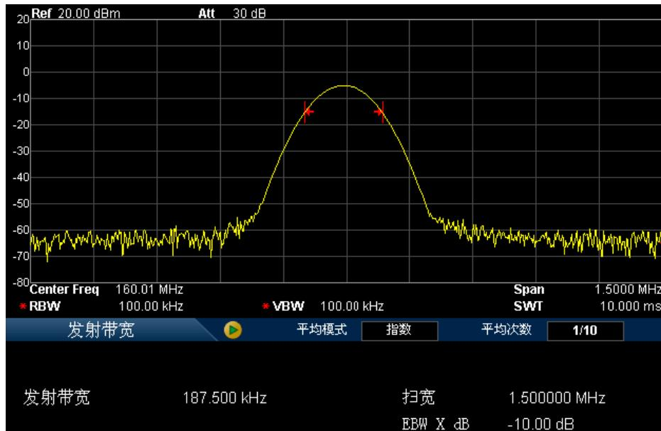
图 2-17 发射带宽测量界面
