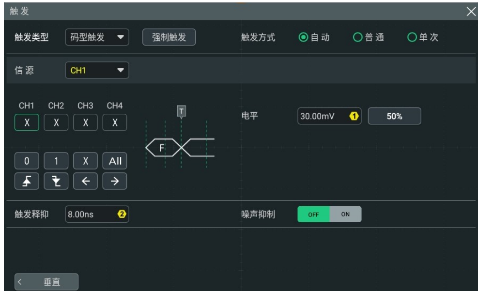
图 8.10 码型触发配置菜单
