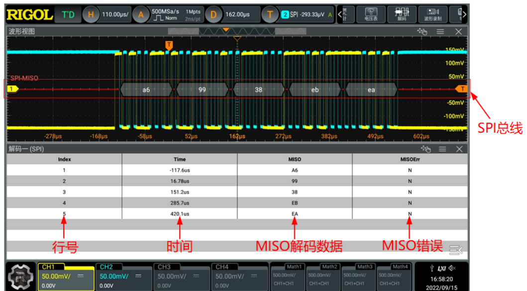
图 15.12 SPI 解码事件表
