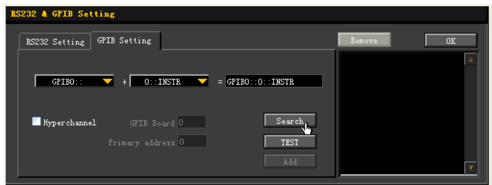
图 22.1 搜索 GPIB 连接设备
