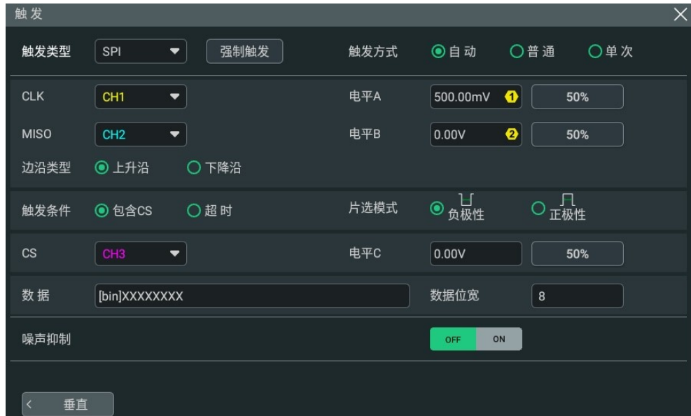
图 8.31 SPI 触发配置菜单
