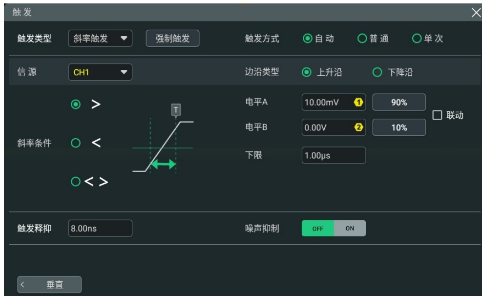
图 8.7 斜率触发配置菜单
