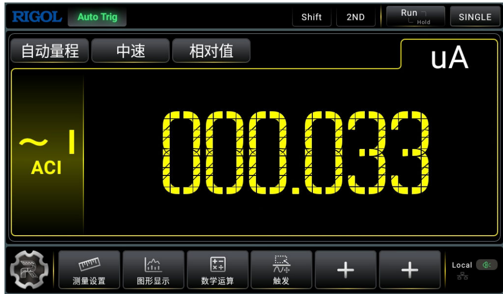
图 5.12 交流电流测量界面
