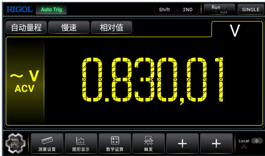
图 5.9 交流电压测量界面
