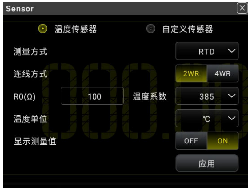
图 5.39 设置温度传感器参数
