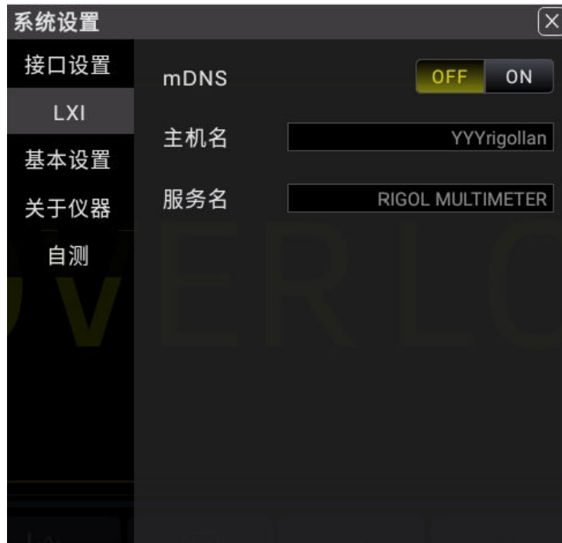
图 5.80 LXI 设置界面
