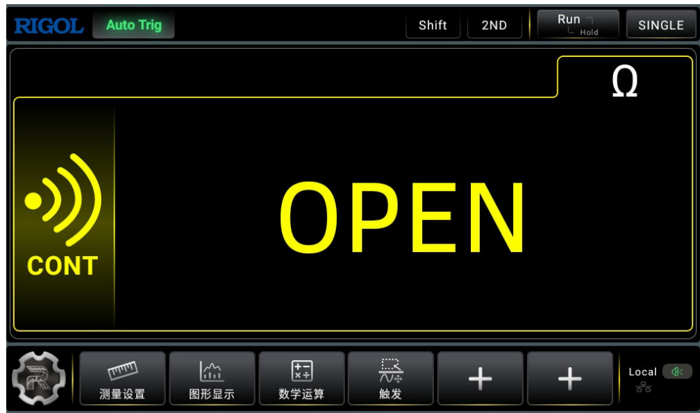
图 5.24 连通性测试界面
