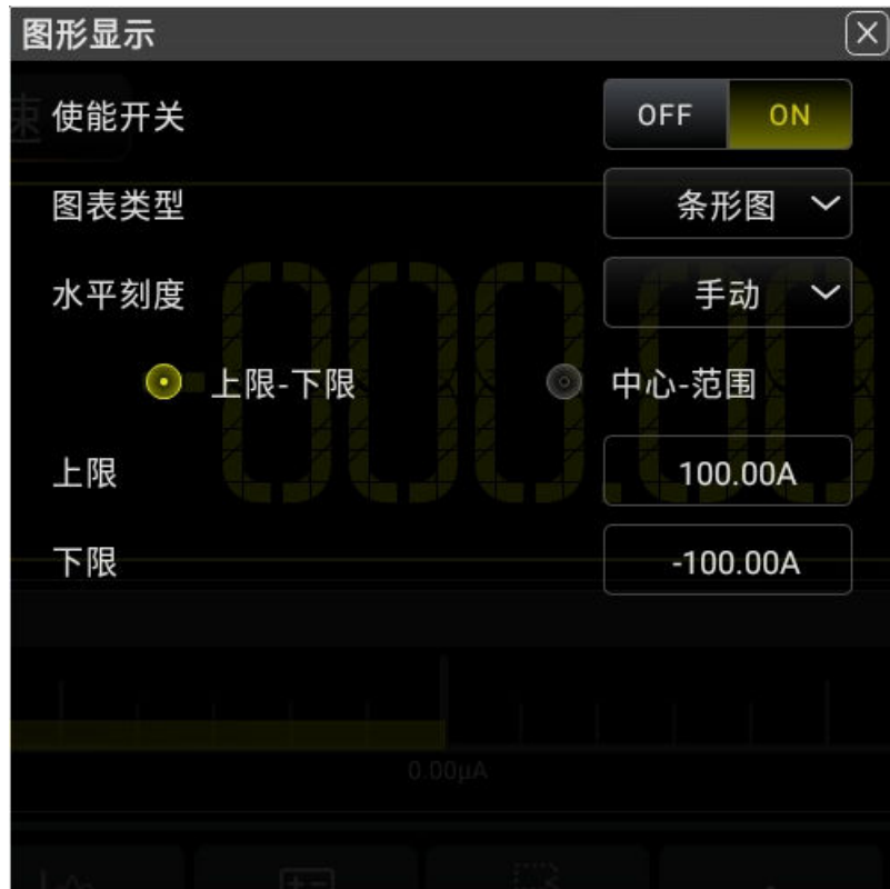
图 5.69 条形图手动设置界面
