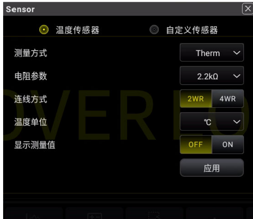
图 5.40 设置 Therm 型温度传感器参数
