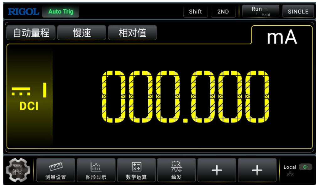
图 5.6 直流电流测量界面
