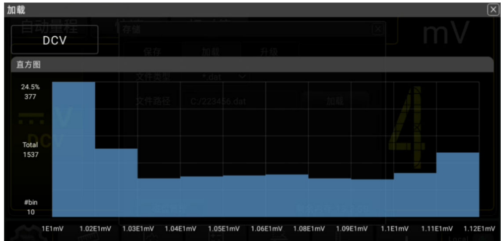
图 5.91 加载数据直方图显示
