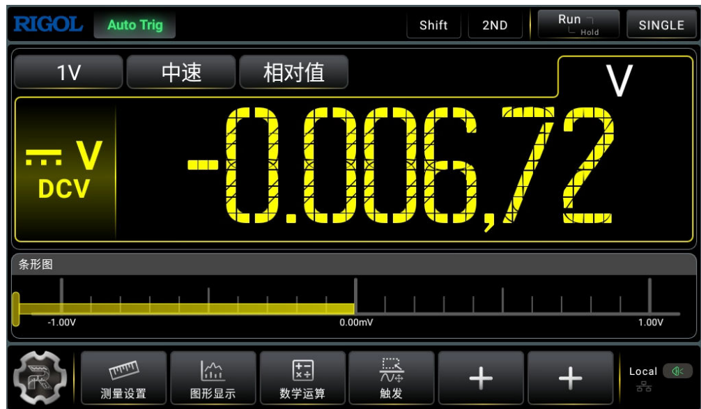
图 5.70 直流电压条形图
