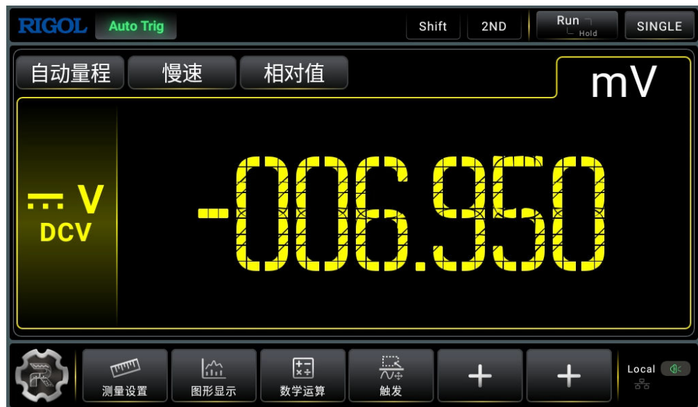
图 5.3 直流电压测量界面
