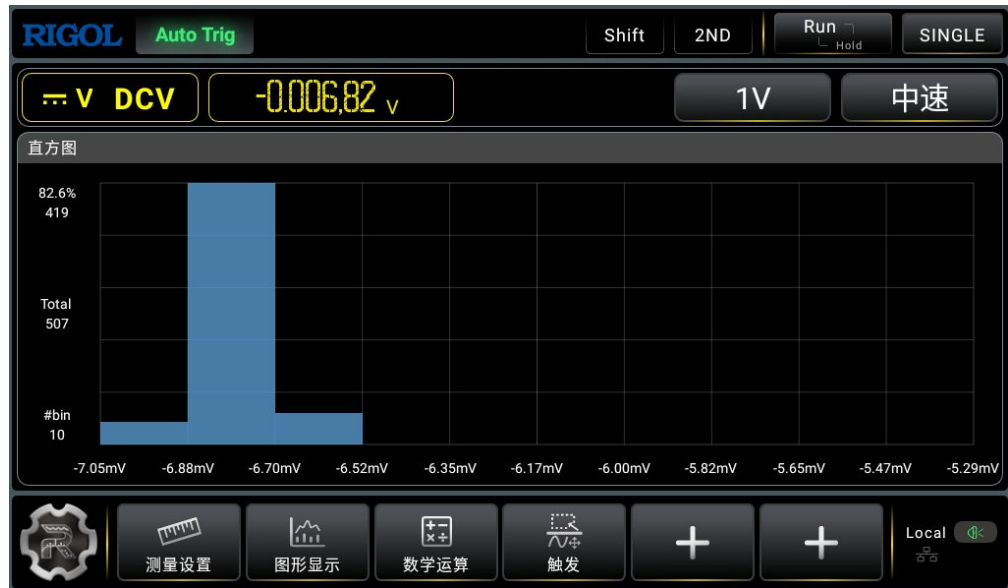
图 5.66 直流电压直方图
