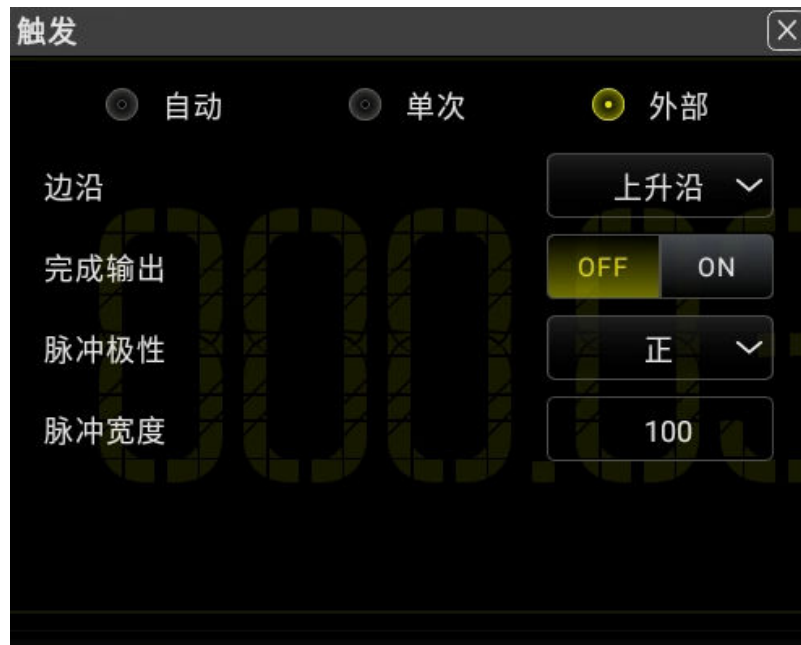
图 5.75 外部触发参数设置
