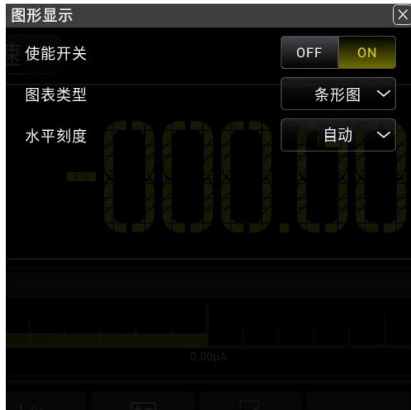
图 5.68 条形图设置主界面
