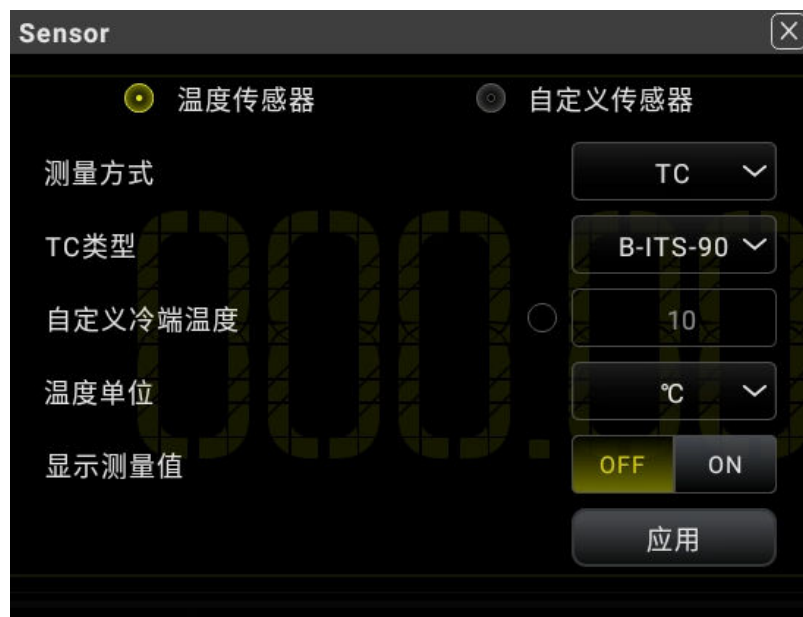
图 5.38 设置温度传感器参数
