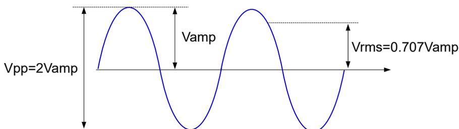
根据上图，可以推导出正弦波 Vpp 与 Vrms 之间换算关系满足如下关系式：
