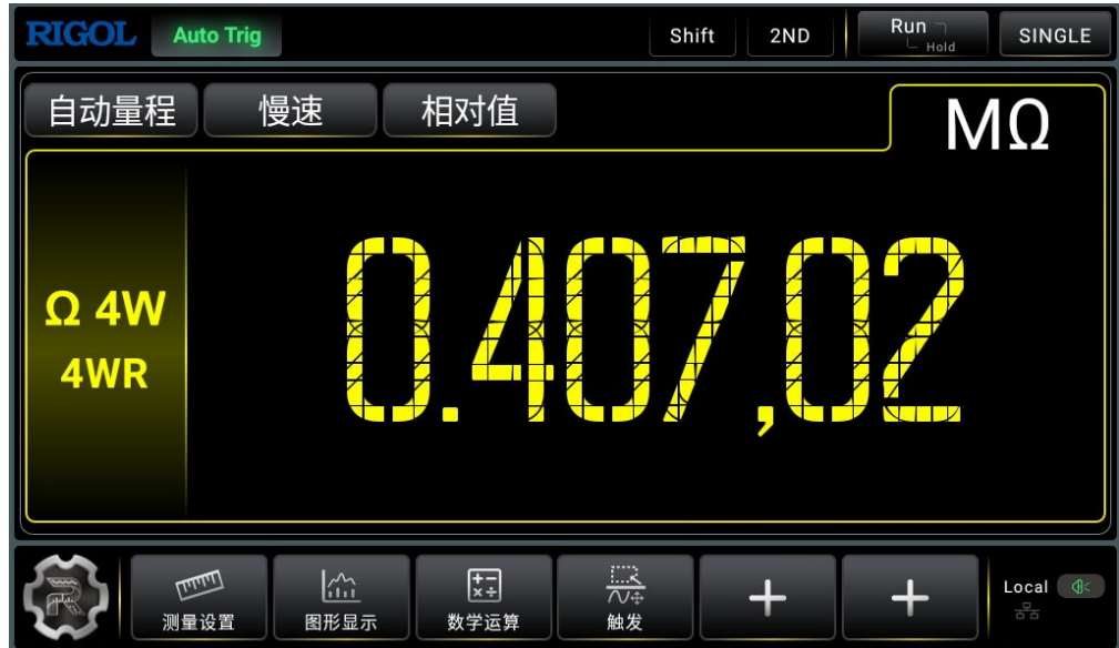
图 5.18 四线电阻测量界面
