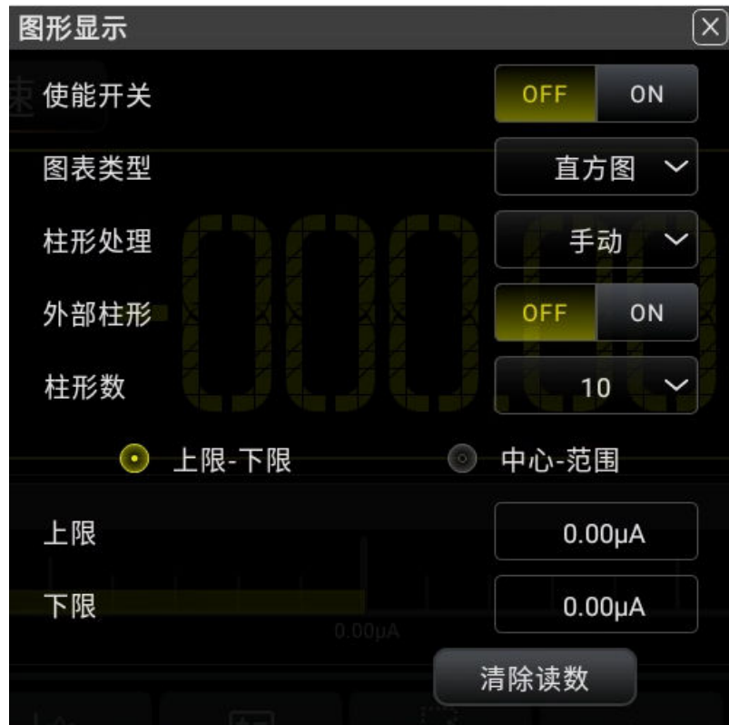
图 5.65 直方图手动设置
