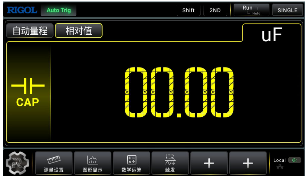
图 5.21 电容测量界面
