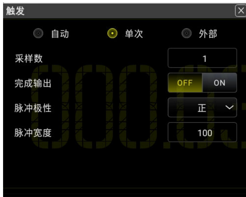
图 5.74 单次触发参数设置
