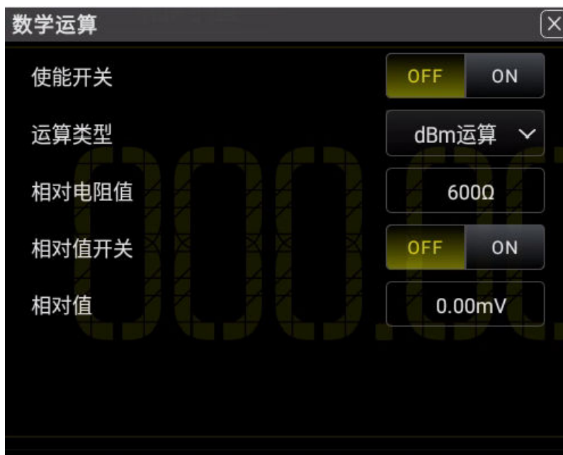
图 5.55 dBm 运算参数设置
