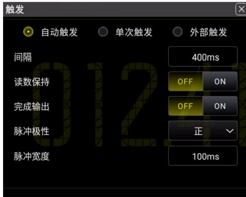
图 5.72 自动触发设置界面
