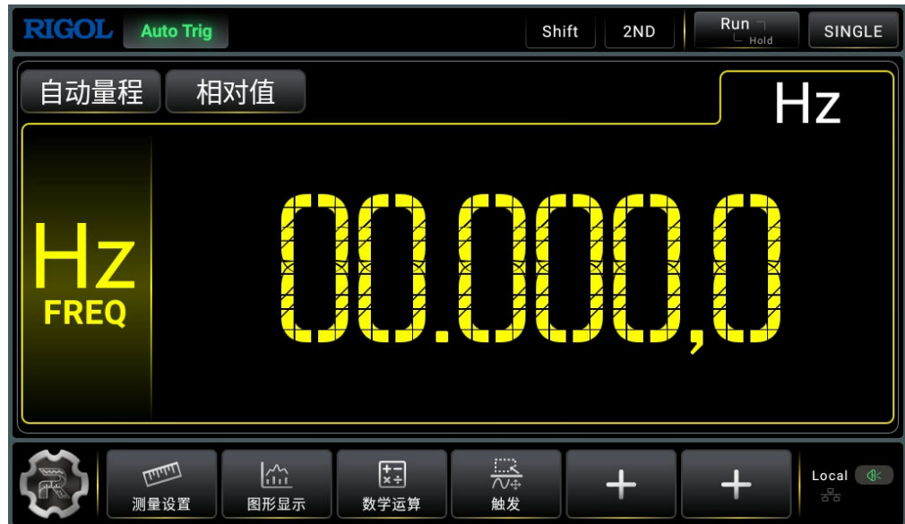
图 5.28 频率测量界面
